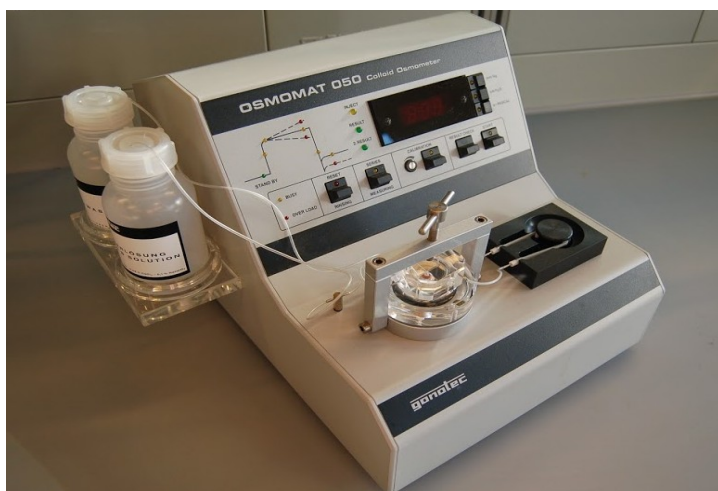
Fotografia 1. Osmometr membranowy Osmomat 050 firmy Gonotec wykorzystywany do wyznaczania masy cząsteczkowej polimerów.
