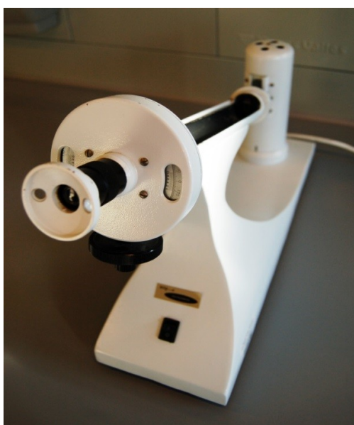
Fotografia 1. Widok ogólny trójpoleowego polarymetru półcieniowego ze źródłem światła – lampą sodową.
