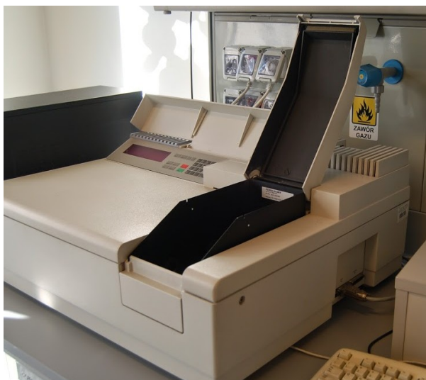
Fotografia 2. Spektrofotometr UV–Vis Lambda 40 firmy Perkin-Elmer wykorzystywany w ćwiczeniu.
