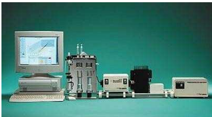
Rys. Zestaw aparatury SX.18MV-R firmy Applied Photophysics, stosowanej w metodzie stopped-flow
