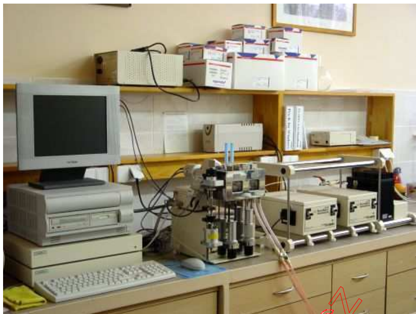
Rys. 5. Zestaw aparatury SX.18MV-R firmy Applied Photophysics, stosowanej w metodzie stopped-flow
