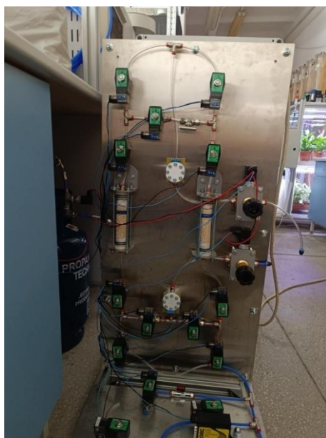
Zdjęcie 1. Stworzona na potrzeby projektu instalacja adsorpcji zmiennociśnieniowej.
