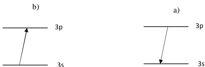
Rysunek 12. Rezonansowe przejście elektronu walencyjnego w atomie sodu związane z: a) absorpcją promieniowania, b) emisją promieniowania
